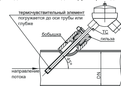
Угловая установка для трубопроводов ≤DN50
