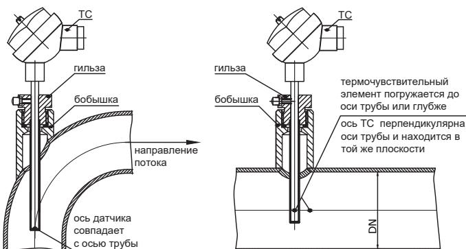
Установка в колене для трубопроводов <DN50
