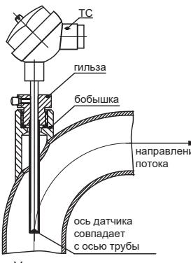
Установка в колене для трубопроводов ≤DN50
