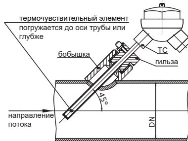
Угловая установка для трубопроводов ≤DN50
