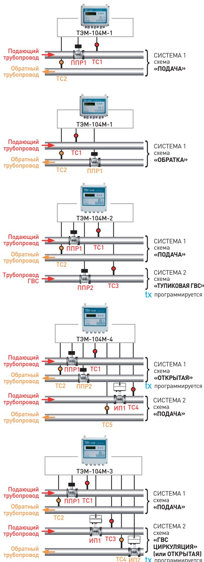
Схема учета для каждой из систем устанавливается пользователем до постановки прибора на коммерческий учет. Предусмотрен выбор любой комбинации из различных вариантов теплотехнических схем учета, что позволяет применять теплосчетчик на объектах теплоснабжения и ГВС любой конфигурации
