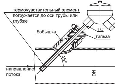
Угловая установка для трубопроводов <DN50
