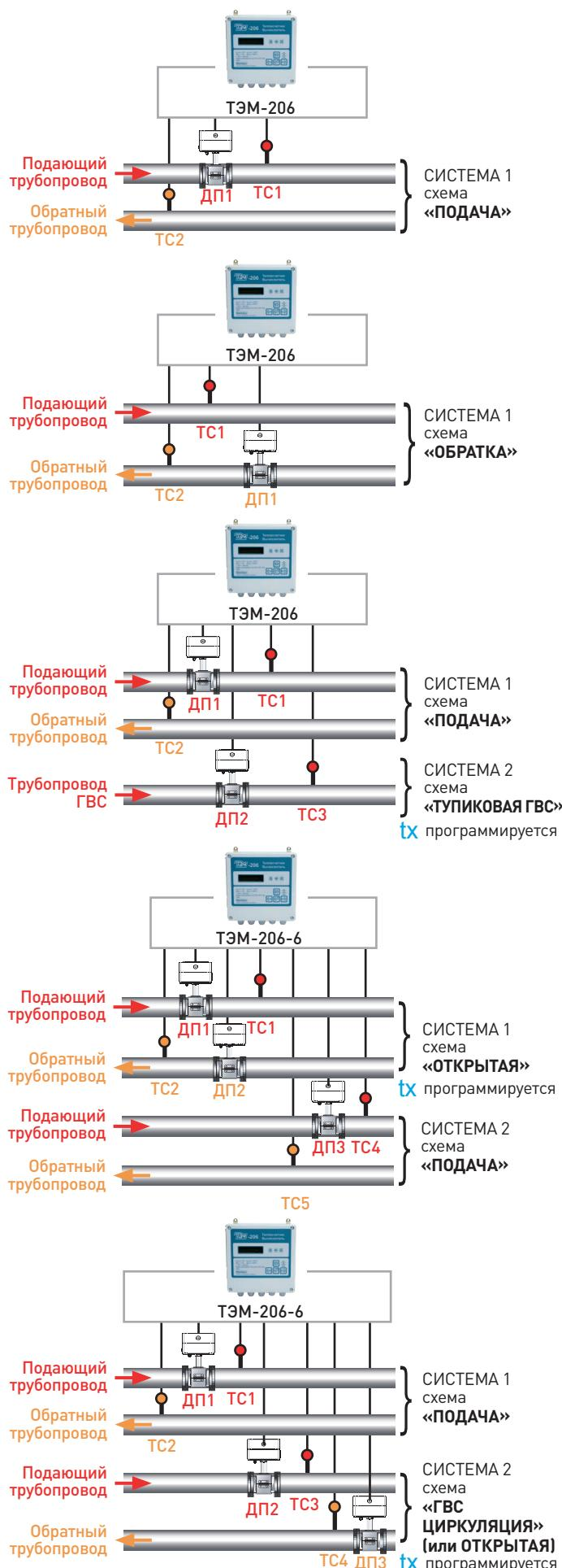
Схема учета для каждой из систем устанавливается пользователем до постановки прибора на коммерческий учет. Предусмотрен выбор любой комбинации из различных вариантов теплотехнических схем учета, что позволяет применять теплосчетчик на объектах теплоснабжения и ГВС любой конфигурации. Для любой из теплотехнических схем возможно применение ультразвукового или электромагнитного расходомеров
