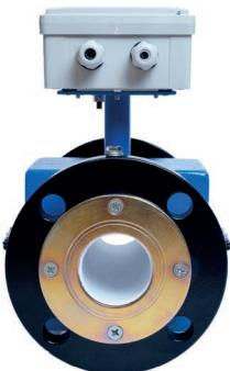
ПРПП — электромагнитный датчик потока с межфланцевым присоединением к трубопроводу (сэндвич) и проточной частью из композиционных материалов
