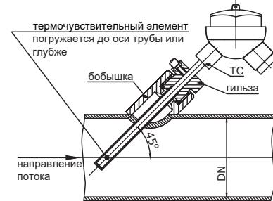
Угловая установка для трубопроводов <DN50
