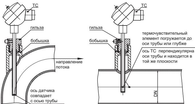
Установка в колене для трубопроводов <DN50
