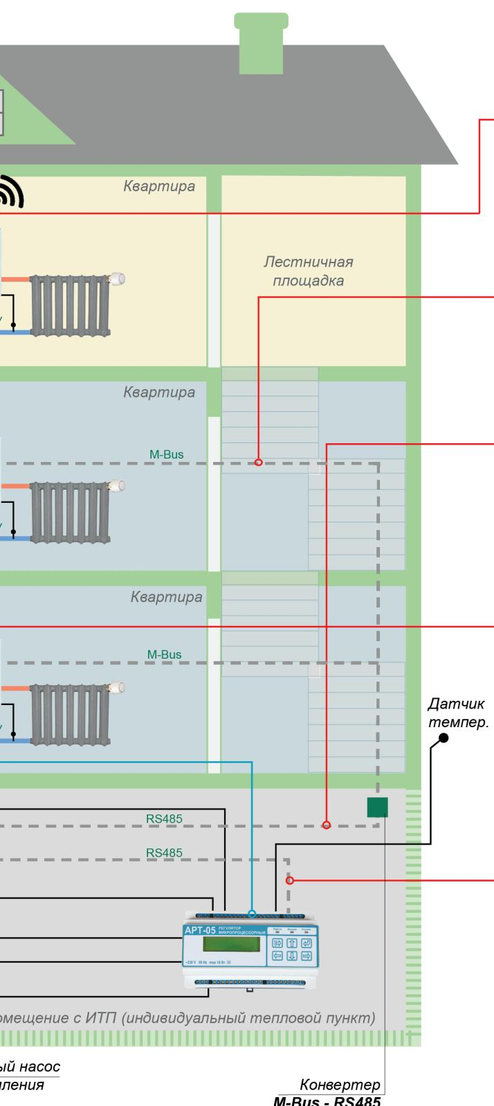
Беспроводное подключение через встраиваемый модуль **NB-IoT** теплосчетчика ТЭМ-104-КУ передает данные в систему **infotel** по сетям мобильных операторов.
