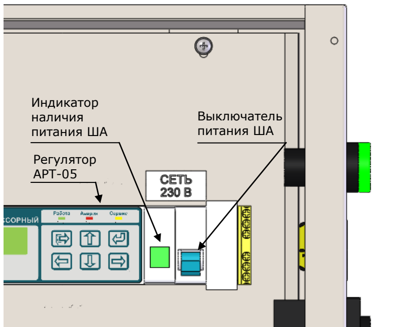
Рис. 7.2а – Назначение элементов управления и индикации, размещенных на защитной панели ША
